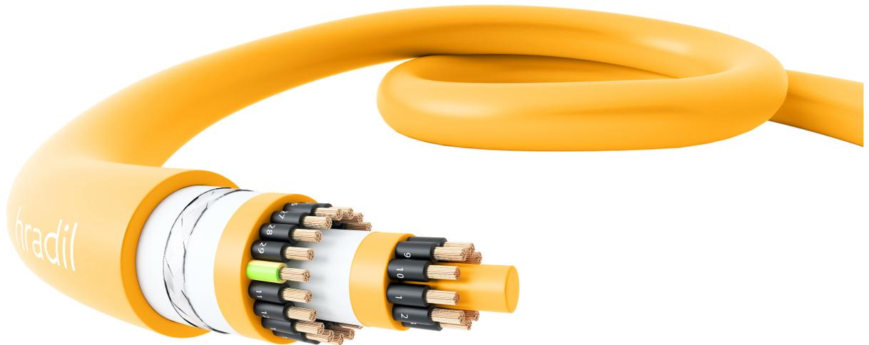
*Abb. 2: HRADIL RINA zertifiziertes Offshore-Steuerkabel HB44<sup>®</sup> mit 30x1.5mm<sup>2</sup> für explosionsgeschützte Bereiche gemäß IEC 60079-14.
