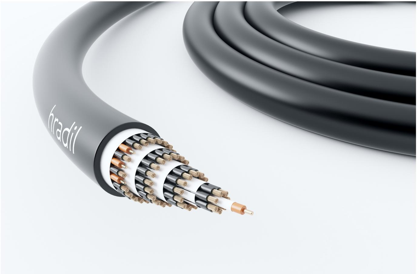
Abb. 1: HRADIL High-Endurance Schleppkettenleitung. Weltweit erste vierlagige 500V Schleppkettenleitung mit 61 Adern.
