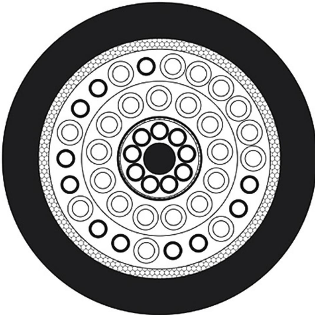
Abb. 2: „New-Generation-Koaxialkabel 4.0“ von HRADIL für UV-Anlagen im Querschnitt
